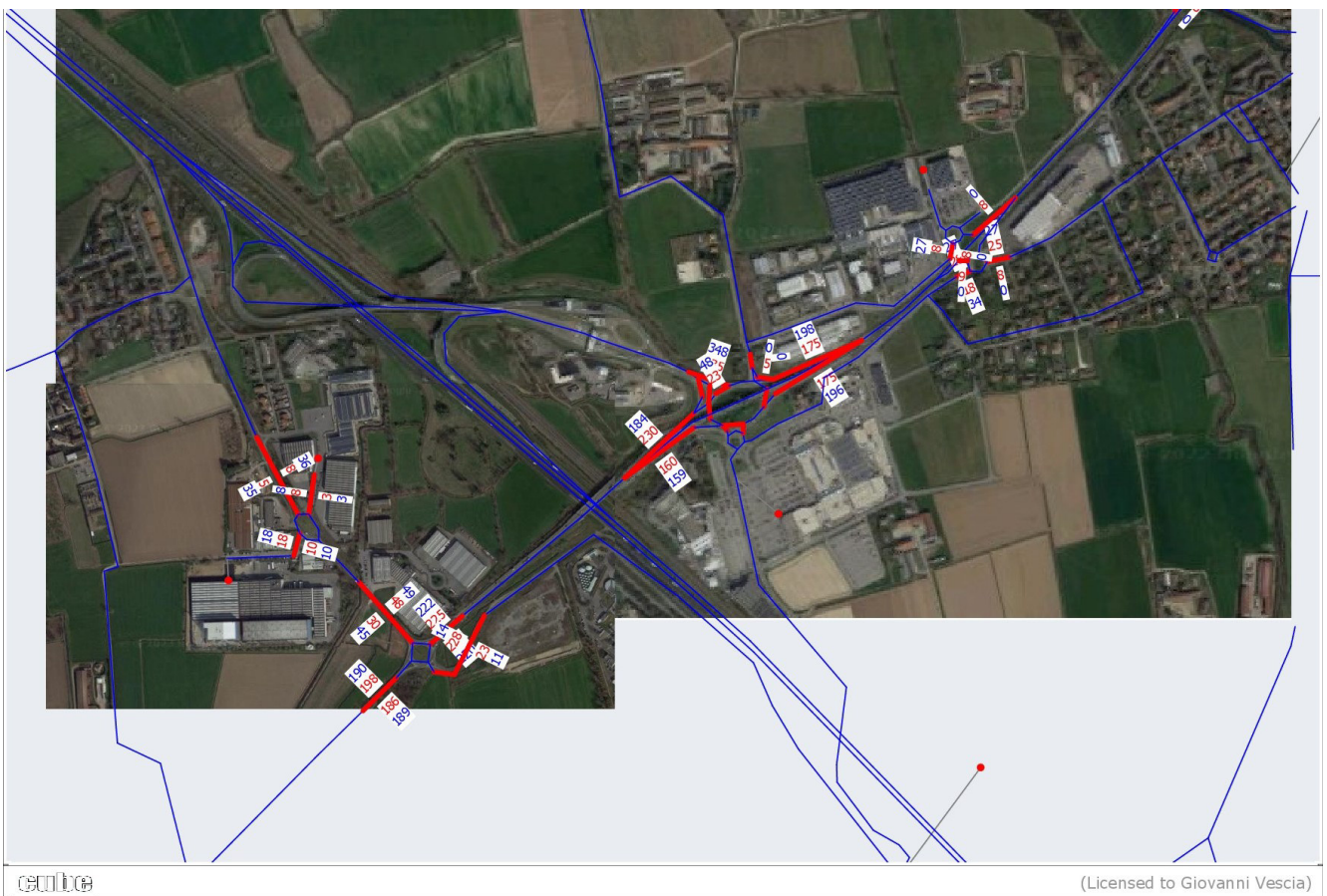
Figura 28 – Raffronto flussi rilevati (in rosso) e simulati (in blu) - HPM – veicoli pesanti
