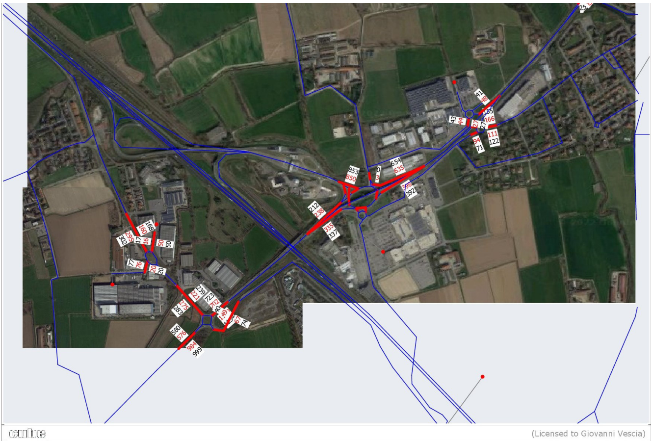
Figura 27 – Raffronto flussi rilevati (in rosso) e simulati (in blu) - HPM – veicoli leggeri
