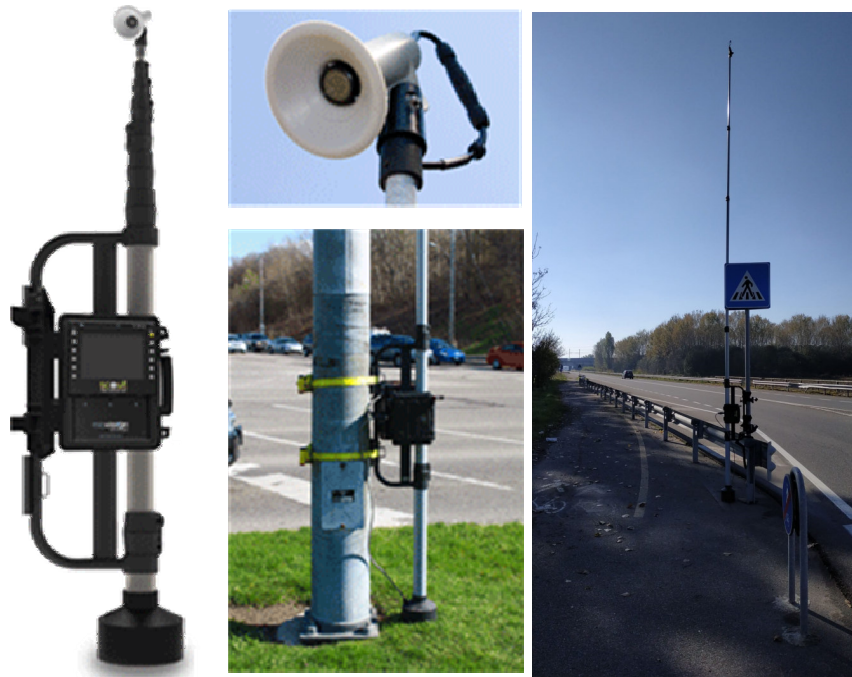
Figura 19 – Strumentazione video con palo telescopico
