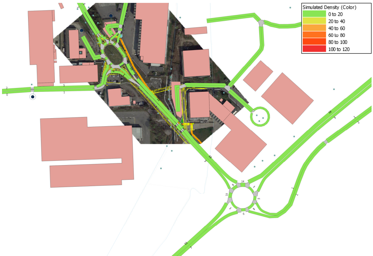
Figura 49 – Scenario 1 di progetto: densità media veicolare rete stradale area di studio – area di studio
